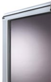
Rahmenprofil mit 20-mm-KS-Doppelscheibe – grau getönt; Lichtdurchlass: ca. 43%
